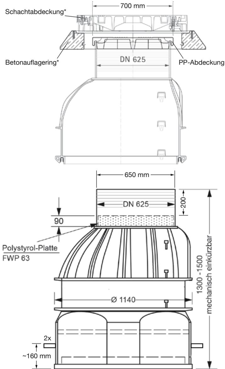
Wasserdichte Abdeckung für Einstiegsöffnung DN 625
