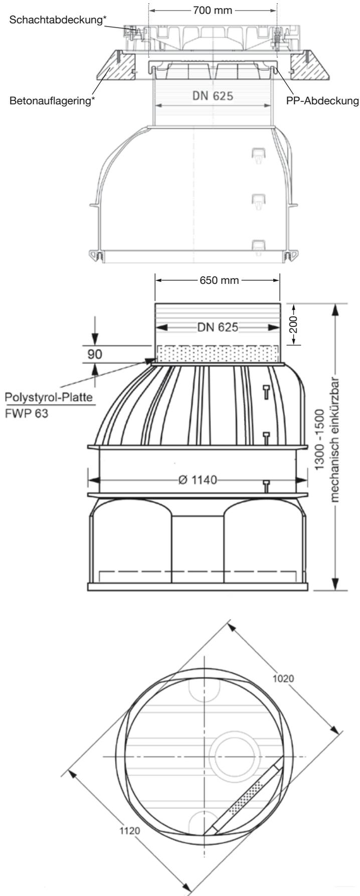
Wasserdichte Abdeckung für Einstiegsöffnung DN 625
