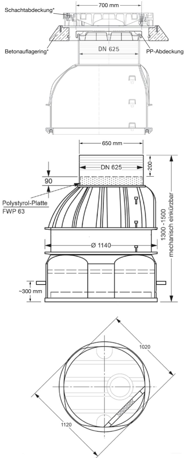
Wasserdichte Abdeckung für Einstiegsöffnung DN 625
