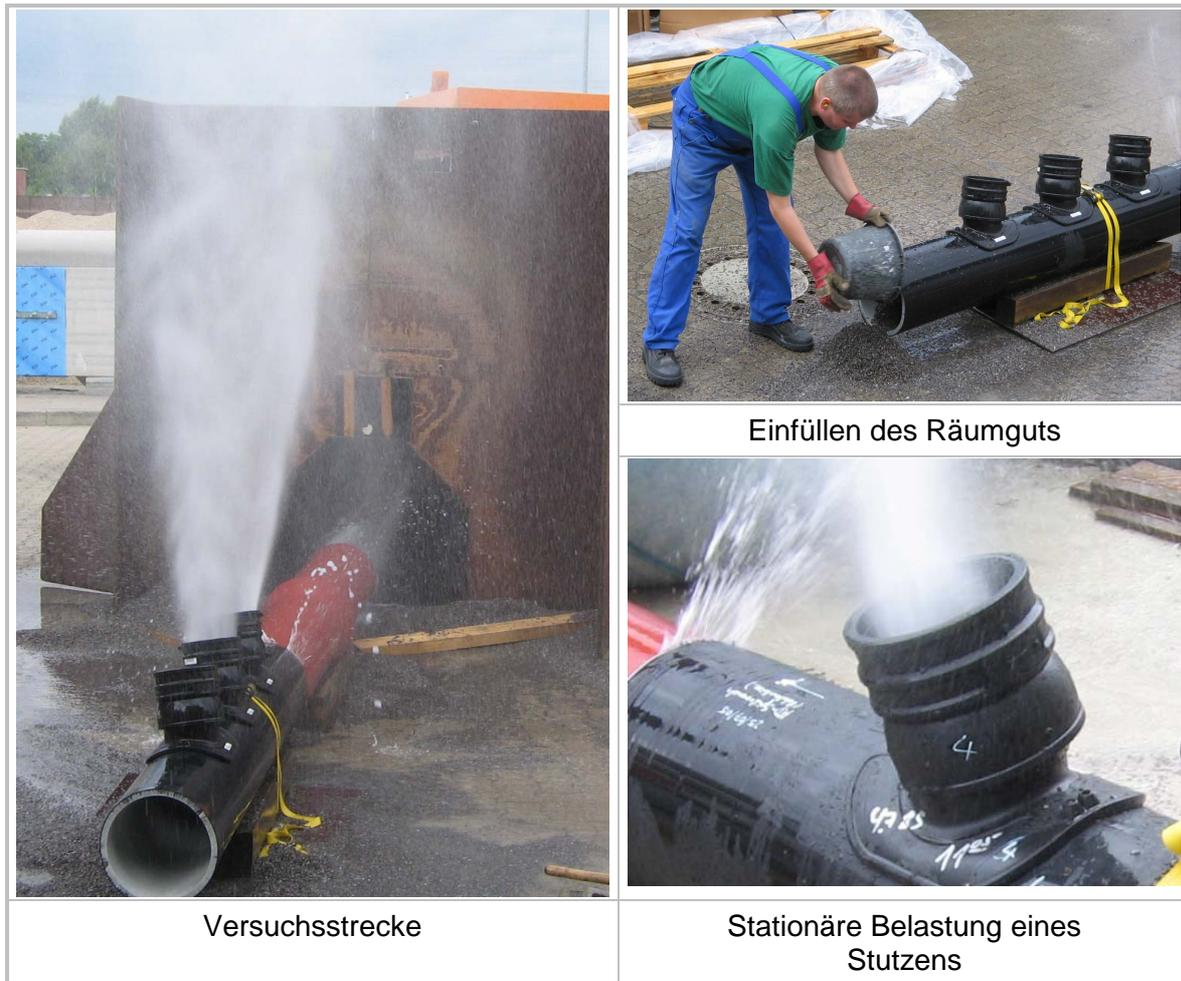
Abb. 6: Versuchsaufbau- und Durchführung der Hochdruckreinigung
