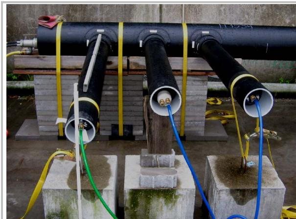
Versuchsaufbau zur Abwinkelung der Anschlussleitungen
