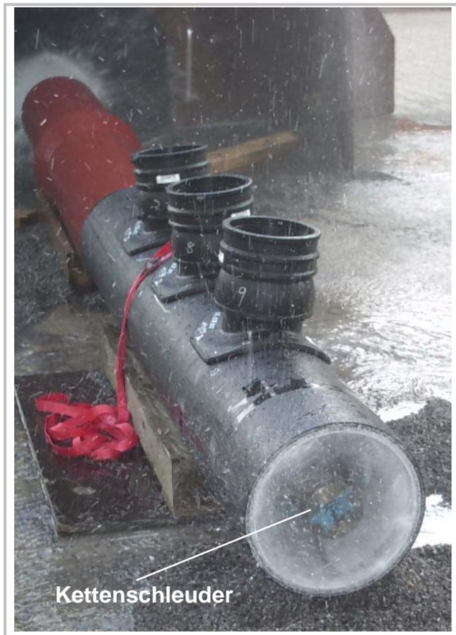
Abb. 7: Versuchsaufbau und Einsatz der Kettenschleuder
