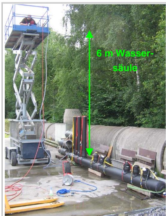
Aufbau der Dichtheitsprüfung
