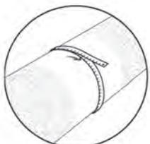
Messen Sie den Außendurchmesser des Rohres mit einem Maßband ab und vergewissern Sie sich, dass die Dimension der Kupplung mit dem Außendurchmesser übereinstimmt.
