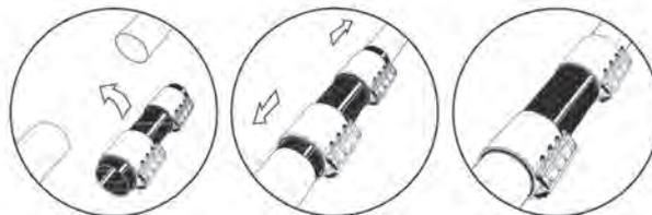
2. Montieren Sie die Kupplungen an den Enden des vorhandenen Rohres. Kupplung nach innen schieben, bis zur auf dem Produktschild angegebenen Einstecktiefe bzw. bis sie die Markierung bedecken.
