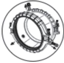
Zentrierstifte lösen. Zum Zurückziehen der Zentrierstifte verwenden Sie einen Gabelschlüssel. Dies erlaubt Ihnen, die Kupplung ungehindert über das Rohr zu stecken und es ordnungsgemäß zu positionieren.
