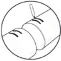
Die Rohrenden entsprechend der nachfolgenden Einstecktiefen markieren, je zwei Linien an jedem Rohr (Minimum und Maximum):
