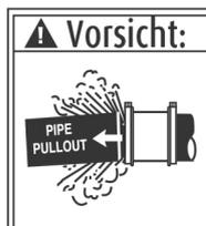
Dieses Produkt hemmt nicht die Axialbewegung des Rohres. Wenn dieses Produkt als Kupplung verwendet wird, ist eine sichere Verankerung des Rohres erforderlich. Werden die Rohrstücke nicht verankert, kann dies zum Austritt des Leitungsinhalts führen und möglicherweise Sachschäden verursachen.
