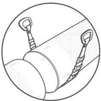
Falls erforderlich, zur Vorbereitung beide Enden des vorhandenen Rohres nach Bedarf mit Wasser reinigen. Stellen Sie sicher, dass das Rohr nicht unrund ist und frei von Korrosions-Ablagerungen, Kratzern, Dellen, Flachstellen und anderen Mängeln, die die ordnungsgemäße Abdichtung der Kupplung beeinträchtigen. Die Dichtigkeit wird auf unrunder oder beschädigten Rohren unter Umständen beeinträchtigt.
