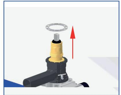
Sicherungsring nach Oben abziehen.
