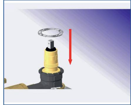
Sicherungsring auf die Armatur aufsetzen.
