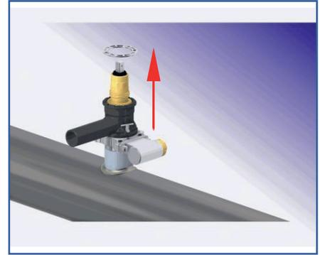
Sicherungsring nach Oben abziehen.
