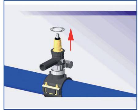
Sicherungsring nach Oben abziehen.
