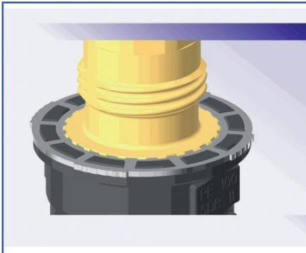
Sicherungsring zentrisch und lagerichtig auf die Stirnverzahnung A aufsetzen.
