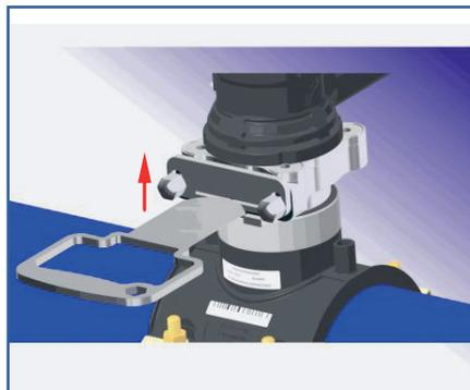
Hutmutter SW13 lösen. Flanschplatte bis Anschlag nach Oben schieben und sichern.
