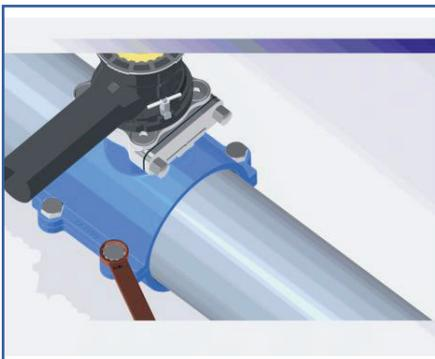
Gewindebolzen wechselseitig gleichmäßig bis zur Flanschanlage Anschluss/Haltestück festziehen.
