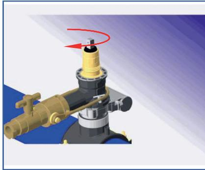
Betriebsabsperung am Spindelvierkant SW14 rechtsdrehend bis zum Anschlag schließen (ca. 6,5 Umdrehungen).
