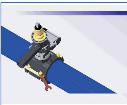
Befestigungsmuttern wechselseitig gleichmäßig nach Herstellerangaben festziehen.
