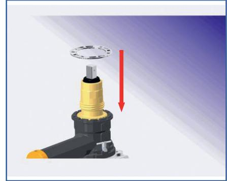
Sicherungsring auf die Armatur aufsetzen.
