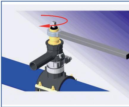
Betriebsabsperung (Oberteil mit 1½-Linksgewinde) rechtsdrehend abschrauben.
