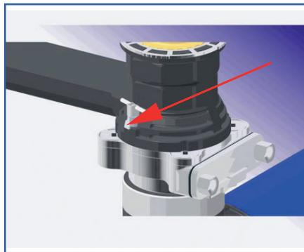
Verriegelung ist gesperrt, Sicherungsbugel zeigt nach unten in Richtung Hauptrohr.
