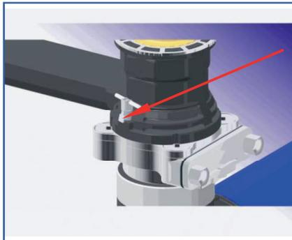
Nach erfolgreich durchgeführter Montage und Prüfung: **Wahlweise** die Verriegelung durch Herunterklappen des Sicherungsbügels entsperren.
