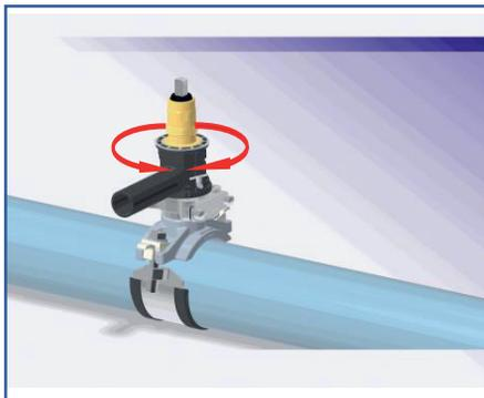
Hauptrohr nach den Angaben des Rohrherstellers vorbereitet. Die Oberfläche des Rohres muss frei von Schmutz, Erdreich und Fetten sein. Das Armaturengehäuse ist im Auslieferungszustand 360° drehbar.
