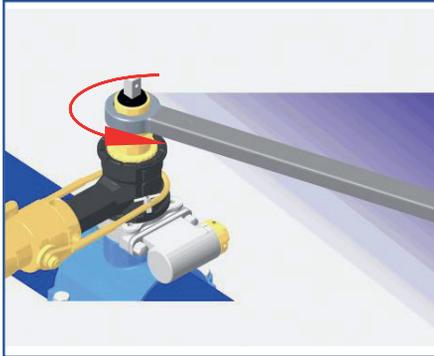
Nach erfolgter Anbohrung Oberteil mit Schlüssel SW40 bis zum merklichen Anschlag linksdrehend anziehen.
