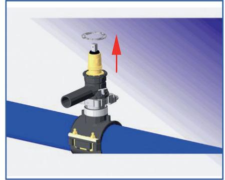
Sicherungsring nach Oben abziehen.
