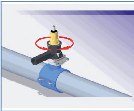
Hauptrohr und Schweißschelle nach Angaben der Hersteller vorbereiten und verarbeiten. Die Oberfläche des Rohres muss frei von Schmutz, Erdreich und Fetten sein. Das Armaturengehäuse ist im Auslieferungszustand 360° drehbar.
