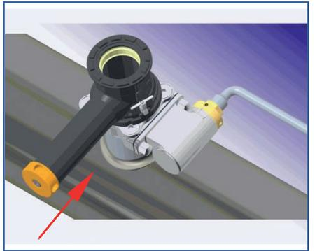
Nach jeweiliger Anschlussmethode ggf. den Abgangsstutzen gasdicht verschließen.
