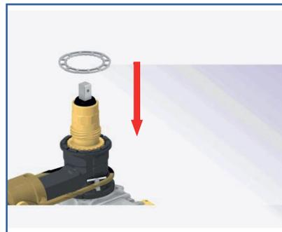
Sicherungsring auf die Armatur aufsetzen.
