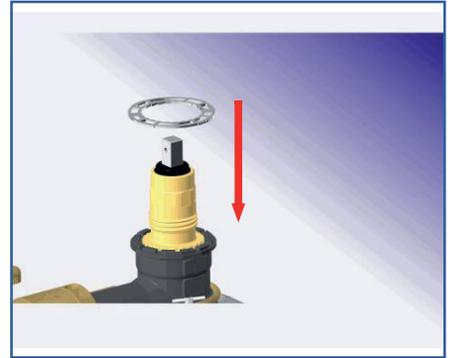
Nach erfolgter Anbohrung Anbohrgerät rechtsdrehend abschrauben. Oberteil mit Schlüssel SW40 bis zum merklichen Anschlag linksdrehend einschrauben und anziehen.
