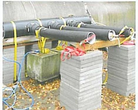
Dichtheitsprüfung unter Scherlastbeanspruchung
