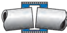
Winkelabweichung bis max. 4° pro Muffe
