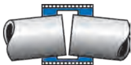
Winkelabweichung bis max. 4° pro Muffe
