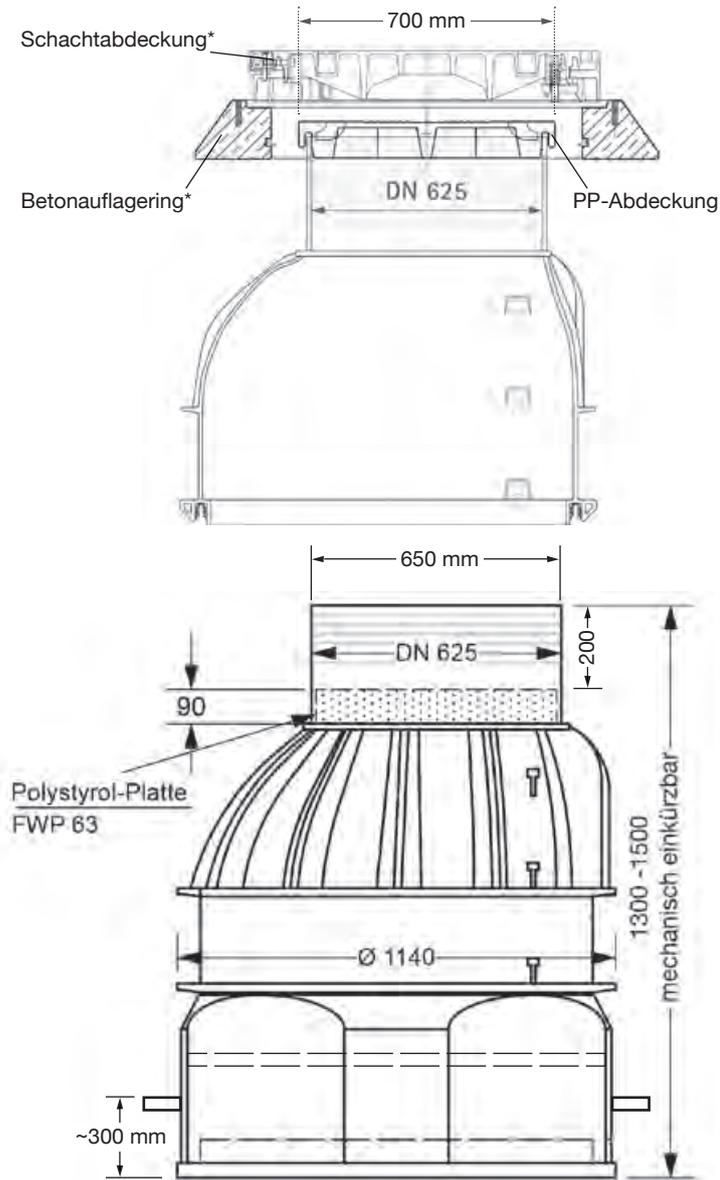
Wasserdichte Abdeckung für Einstiegsöffnung DN 625
