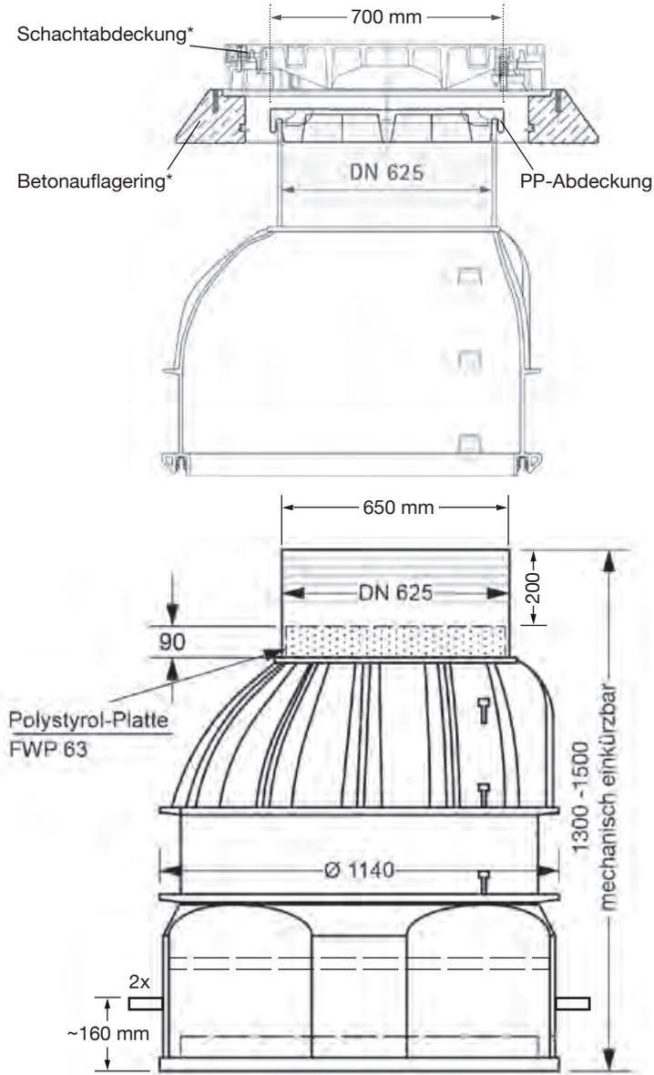
Wasserdichte Abdeckung für Einstiegsöffnung DN 625
