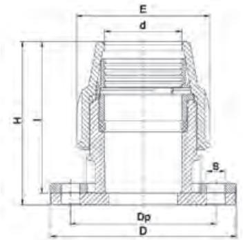
Abbildung und technische Zeichnung für die Dimensionen 50 mm bis 63 mm
