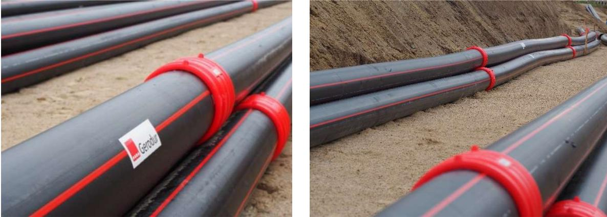
Bild 4: Dreiadrige Verlegung mit EMDS LHT® Rohren der Gerodur MPM Kunststoffverarbeitung GmbH & Co. KG
