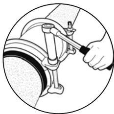
Die Verwendung eines Drehmomentschlüssels ist erforderlich.
